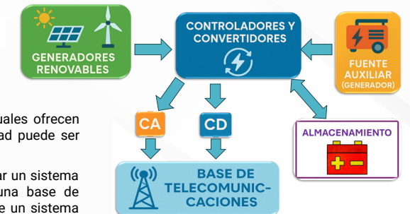
Fig. 1. Estructura simplificada de un sistema híbrido de energías renovables
