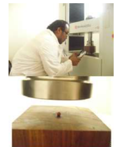
Figura 4.- Colocación de muestras y utilizado de la máquina SHIMADZU para determinar la dureza de los frutos
