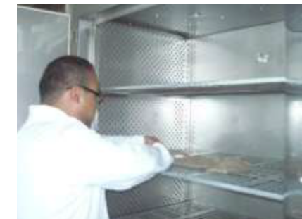
Figura 2.- Colocación de las muestras en la estufa para determinar la humedad inicial
